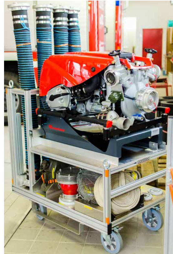
Rollcontainer 1 mit neuer Tragkraftspritze vom Typ „Fox“
